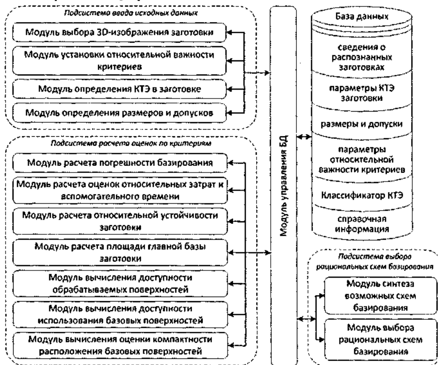
Рис. 2. Структурная схема автоматизированного программного комплекса выбора рациональных схем базирования заготовки
