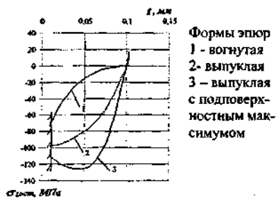
Рисунок 1 — Типичные эпюры осевых остаточных напряжений \sigma_{ост} после ПЦД сталей: 1-обработка микрошариками; 2-обкатка роликом; 3-гидродробеструйная обработка.
