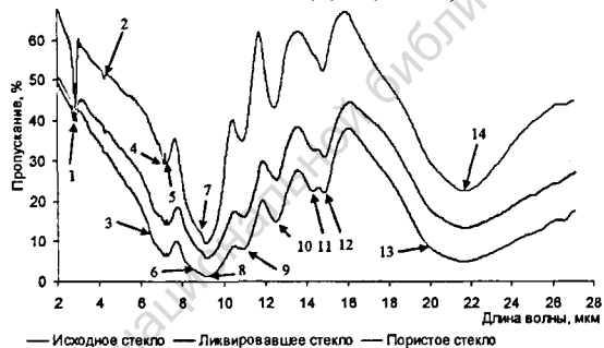
Рис. 8. ИК-спектры синтезированных стекол (числами обозначены характеристические пики основных структурных элементов)
