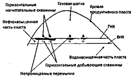
в) расположение горизонтальных нагнетательных скважин при наличии непроницаемой перегородки в области ГНК
