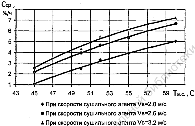
Рисунок 6 – Графическая зависимость средней скорости сушки обножки от температуры сушильного агента.
