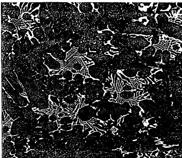
Рисунок 3 – Ледебуритная эвтектика, имеющая скелетное строение; образец № 3 с увеличенным временем индукционного нагрева
