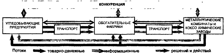
Рис. 1. Промышленный комплекс производства металлургического кокса как логистическая система
