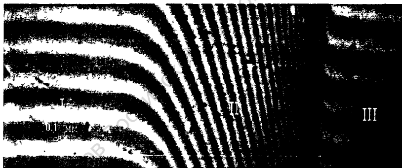
Рис. 3. Интерферограмма диффузионной зоны в системе ПЭГ-400 (слева)/ПВП-2+19%ПЭГ-400. Время контакта 25 мин. T = 80^{\circ}\text{C} . I-фаза чистого ПЭГ, II – фаза смешанных растворов ПВП/ПЭГ, III – фаза ПВП-2+19%ПЭГ-400.
