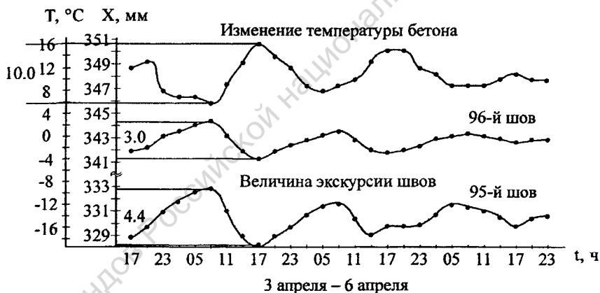
Рис. 3. Результаты мониторинга экскурсии швов в международном аэропорту "Манас": X – расстояние между маяками, по которым измерялось раскрытие деформационных швов (мм); T – температура в районе расположения аэропорта ( ^\circ\text{C} ); t – время проведения измерений (ч)
