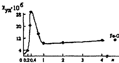
Рис.2. Зависимость \chi_{уд} от содержания железокислородных групп при H=8,28 \text{ кЭ} и T=293\text{К} , где n – количество нанесенных монослоев; Fe-G – феррогель
