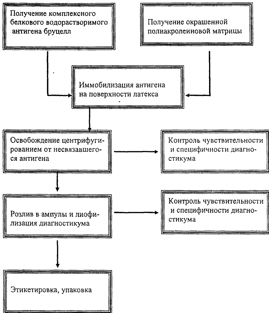
Рисунок 2. Принципиальная технологическая схема изготовления суспензионного бруцеллезного диагностикума для РАЛ
