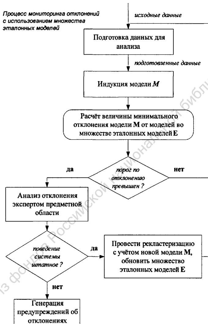
рис. 4. Методика интеллектуального мониторинга с использованием множества эталонных моделей и динамическим обновлением эталонов.
