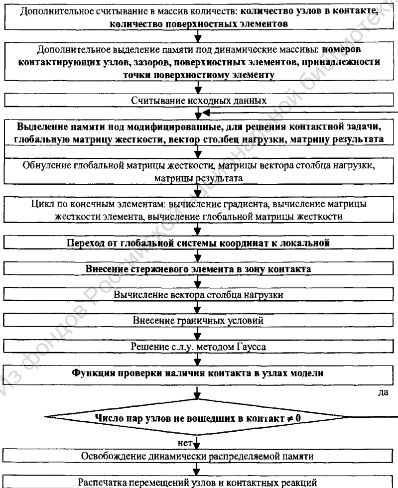
Рис.6. Блок-схема вычислительного процесса контактной задачи
